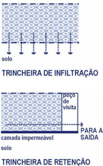
Figura 5.3– Trincheira de infiltração e de retenção (Azzout et al, 1994)
