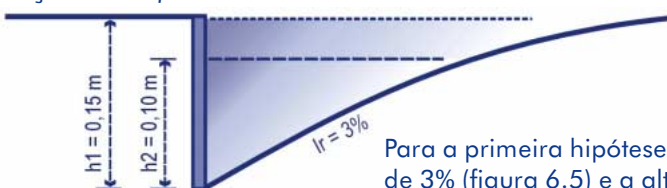
Figura 6.5- Seção da sarjeta
