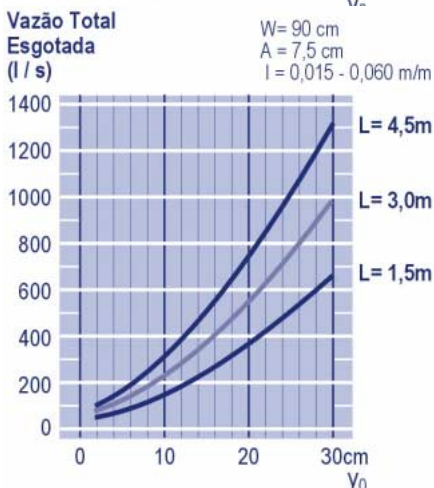
Figura 6.8- Capacidade de engolimento (DAEE/CETESB, 1980)
